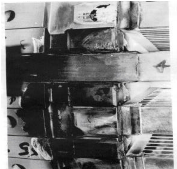
Fig. 2. Ejemplo del daño en la cuñas en la zona de interfase en donde se traslapan las cuñas con el anillo de retención.
