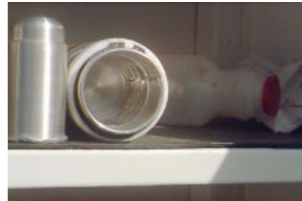
Foto 2: Otra vista de la fisura en donde se dañó la barra de mando a la izquierda se ve el relleno interno para el ponchado.
