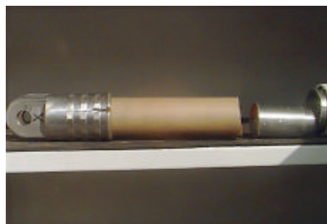
Foto 3: Se observa la parte inferior de la barra de mando también con fisura.
